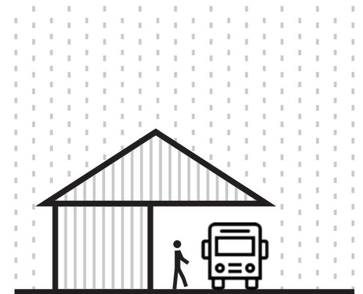
NOVO POTNIŠKO SREDIŠČE asimetrično izmaknjen volumen strehe zaprti del objekta in globok napušč
