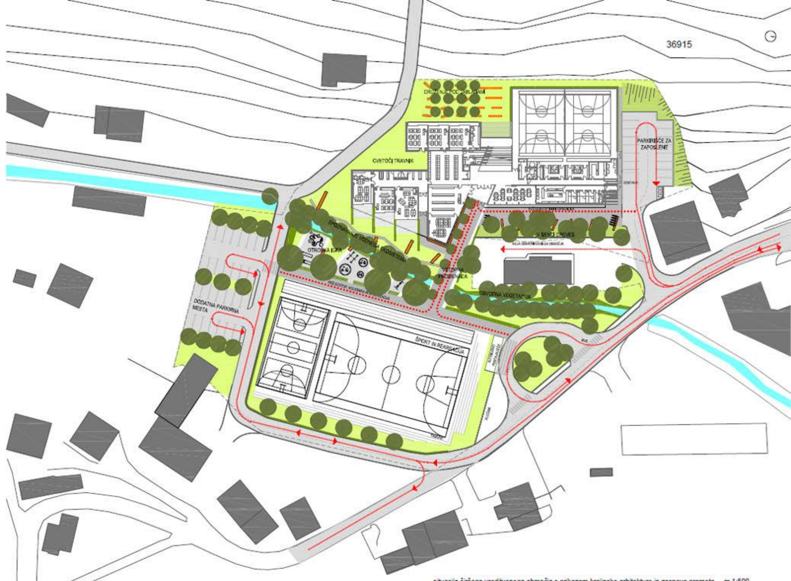
situacija širšega ureditvenega območja s prikazom krajinske arhitekture in zasnovo prometa m 1:500
