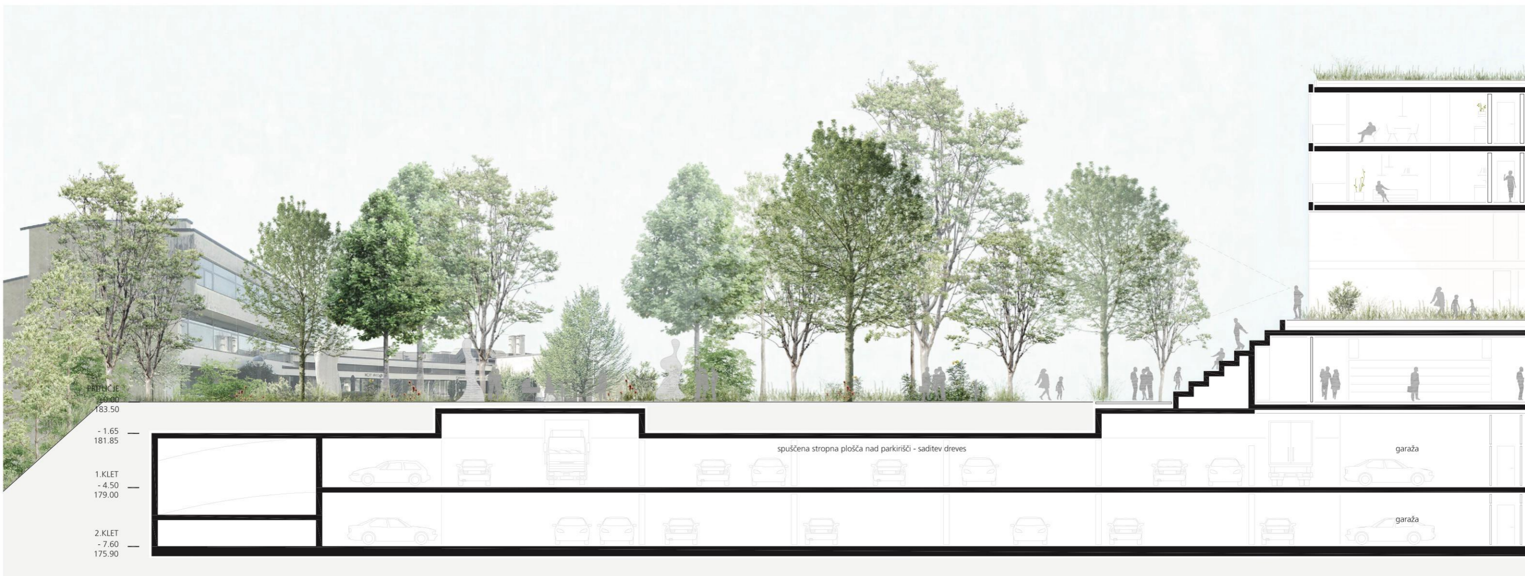
PREČNI PREREZ ČEZ MESTNI PARK IN GARAŽO_1:200
