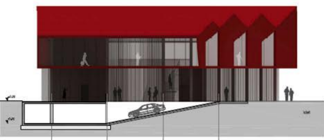
prečni prerez B-B in severna fasada M 1:200
