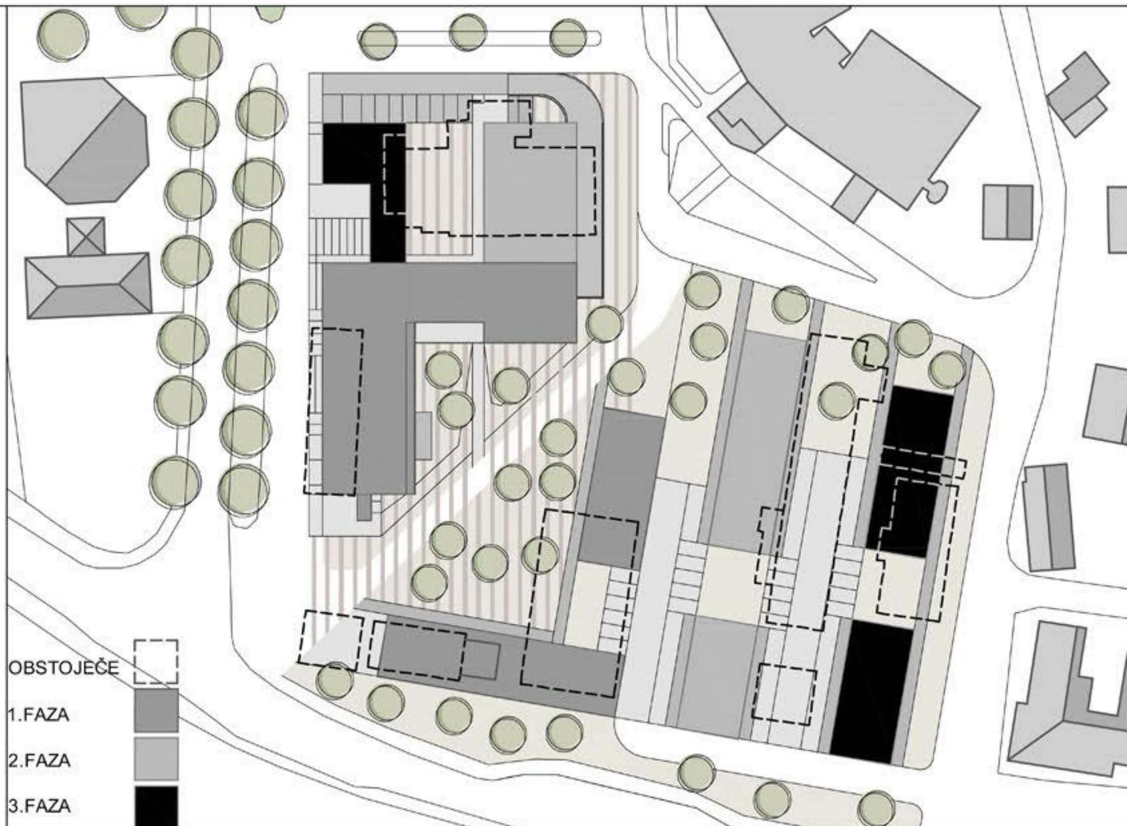
PRIKAZ FAZ IZGRADNJE Merilo 1:500
