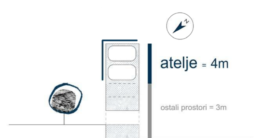
VIŠINA ETAŽ DOLOČA PROGRAM IN POGOJE OSVETLITVE
