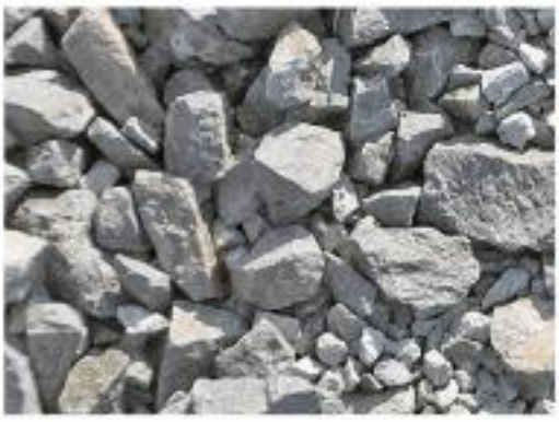
Ves beton je narejen iz reciklirnega granulata.
