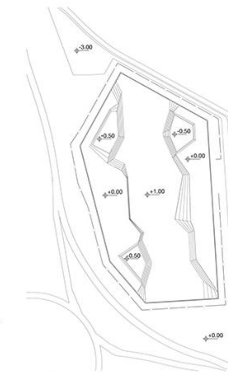
4. JEŽA Teren celotnega kompleksa Zapora se spušta v smeri jug sever, proti reki. Za idom je teren razdeljen v tri pasove. Sredinski, na katerega so postavljeni bivalni stavbi pripora i zapora ter osrednja stavba, se spušta v proti zahodu in vzhodu, kot da bi reka ustvarila v tem območju dve ježi.
